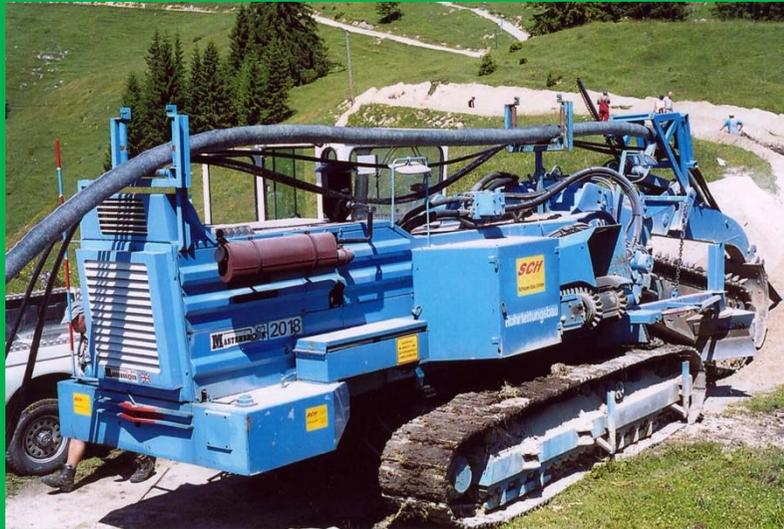
Die Fräse, die alle beeindruckt hat. Sie fräste sauber und schnell durch jeden Untergrund und verlegte gleichzeitig alle Kabel und das Abwasserrohr.
